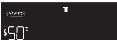
Modo temperatura de impulsión
